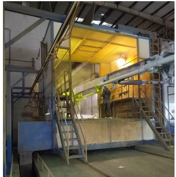
移动喷漆房及集气装置
